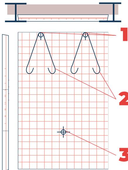
**1** 2 réservations cylindriques permettant un accès dégagé aux ancrages de levages
