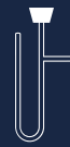
Détermination de la finesse par la méthode de Blaine (valable sur d'autres composants)
